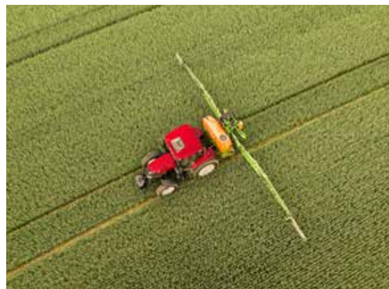
AFS AccuGuide: Op GPS- en GLONASS-gebaseerde spoorgeleiding
