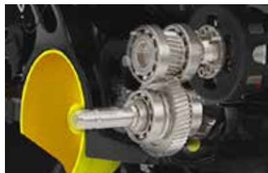
Directe vermogensoverdracht van motor naar frontaftakas.
