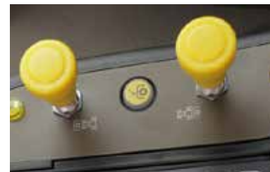
Elektrohydraulische inschakeling van de achter- en frontaftakas.
