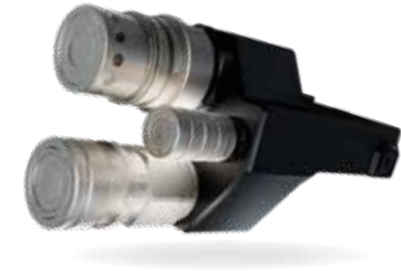
Oliemotoren of werktuigen die veel vragen van het hydraulisch systeem kunnen via de Power Beyond-aansluiting worden gevoed met 110 liter olie per minuut.
