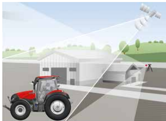
xFill overbrugt RTK+ signaalverliezen van maximaal 20 minuten
